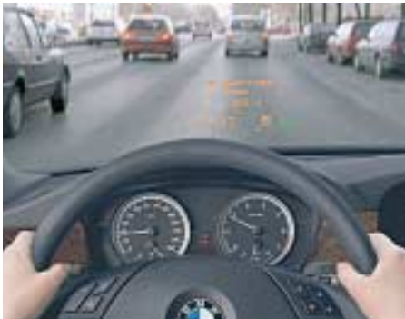
Abb. 1: Erscheinung eines „schwebenden“ Bildes Die neue BMW 5er Reihe bietet dem Fahrer die futuristische Option, Tachometer, Kraftstoffanzeige, Warnmitteilungen, Navigationshinweise usw. konzentriert in Augenhöhe auf der Frontscheibe in einem DIN A5 großen, scheinbar schwebenden Bild in Farbe und ohne Konfigurationsgrenzen zu sehen. Bei dieser Technik werden die Fahrdaten in das normale Sichtfeld des Fahrers auf der Frontscheibe projiziert und bilden in 2 Meter Entfernung von der Frontscheibe in Höhe des Kühlergrills ein virtuelles Bild.
